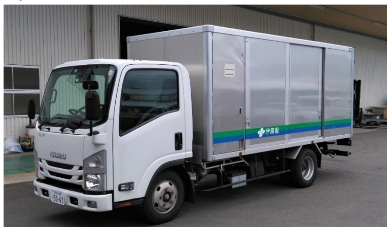
110kg の軽量化に成功したモデル車両（架台のドアパネル、床材に「茶殻配合軽量パネル」を使用）と、茶殻配合軽量パネル（茶殻配合 TECCELL）
